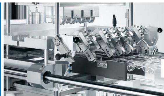
Blisterformstation mit Folien-Längsschneidvorrichtung
