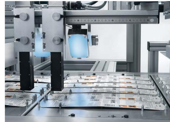
Beispielhaftes Druck- und Kamerasystem beim Drucken und anschließenden Prüfen variabler Produktdaten
