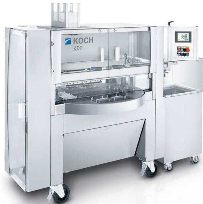
Die Drehtischmaschine KDT – ausgelegt mit vier Stationen zum Siegeln unterschiedlicher Produkte von klein bis groß
