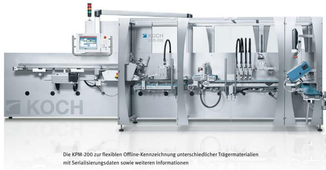
Die KPM-200 zur flexiblen Offline-Kennzeichnung unterschiedlicher Trägermaterialien mit Serialisierungsdaten sowie weiteren Informationen
