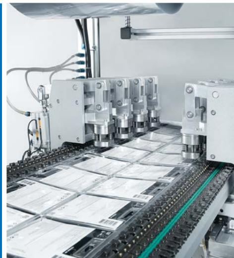
Kettentransport der Blistermaschine KBS-KF mit Stanze zur Euro-lochung des Blisters
