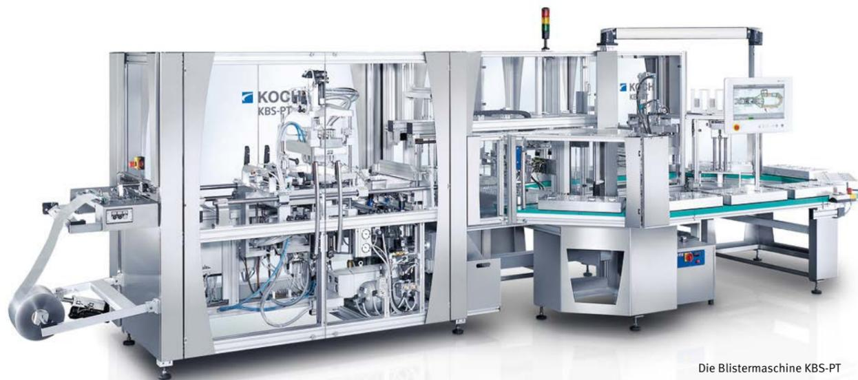
Die Blistermaschine KBS-PT mit Folienzuführung, Formstation, Siegelstation und achteckig ausgelegtem Palettentransport
