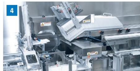
Die Wallets werden in Stapeln aus sieben Stück an den Kartonierer C 200 von Uhlmann übergeben.
