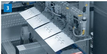
Ein komplett neu entwickeltes Faltsystem ermöglicht viele Achsbewegungen und kann die enorme Vielfalt der Blisterformate abbilden.
