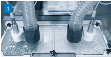
Die SimTap-Zuführung der Blistermaschine B 200 platziert Tabletten in bis zu drei unterschiedlichen Dosierungen pro Blister zuverlässig in die richtigen Aluhöfe.
