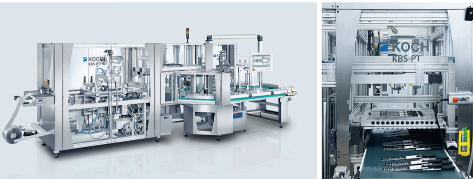
Schnelle Formatwechsel, hohe Verpackungskapazität und Flexibilität beim Verarbeiten unterschiedlicher Formate und Materialien. Dafür steht das Maschinenkonzept der Blistermaschine KBS-PT.
